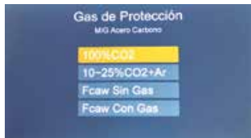
FCAW Sinérgico con y sin gas de protección
